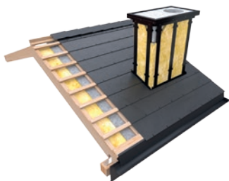
Rys. 2 Wypełnienie wełną mineralną o grubości minimalnej 50 mm.
