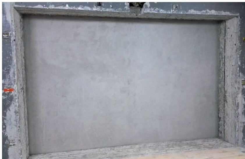
Badanie właściwości akustycznych bloczka dBlok w laboratorium ITB w Warszawie
