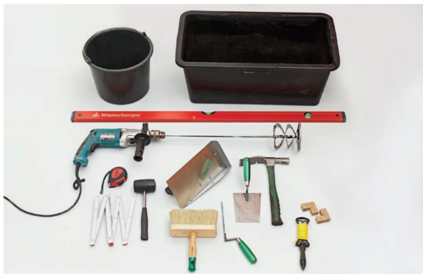
Narzędzia potrzebne do wznoszenia ściany elewacyjnej.
