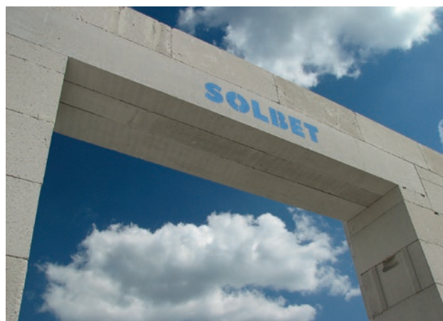
Nadproża SOLBET dostępne są w dwóch szerokościach – 12 i 18 cm. Układając je obok siebie (2 x 12 + 18) można uzyskać szerokość 42 cm, czyli szerokość odpowiadającą grubości bloczków SOLBET Ideal.
