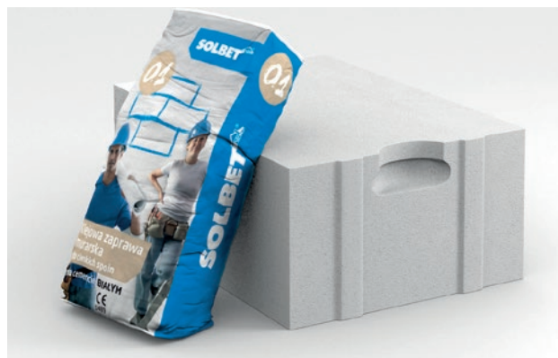
Do wykonywania ścian jednowarstwowych stosuje się bloczki SOLBET Ideal. Są to materiały murowe o klasie gęstości 400 i szerokości 42 cm. Muruje się je na murarską zaprawę cienkowarstwową SOLBET.
