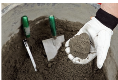
Prawidłowa konsystencja zaprawy.
