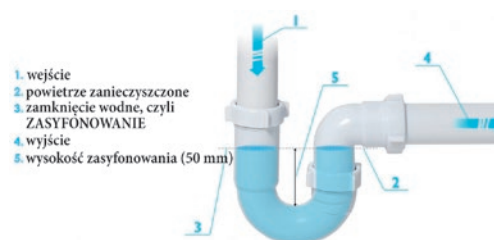
Schemat syfonu rurowego
