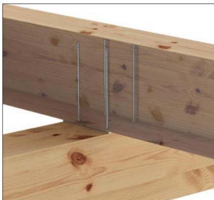
Wzmocnienie w miejscu podparcia
