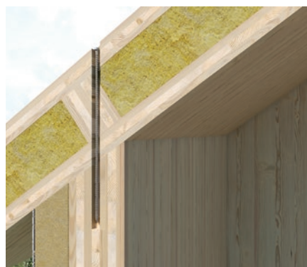
Wkręty WKFC – połączenie ściana-dach z CLT
