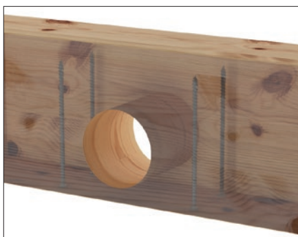
Wzmocnienie belki w miejscu osłabionym otworem
