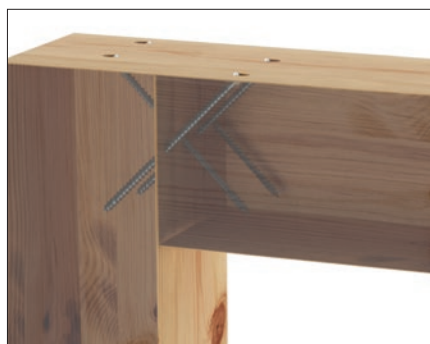
Połączenie dwóch belek
