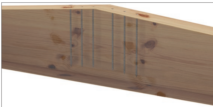
Wzmocnienie wkrętami w strefie kalenicowej
