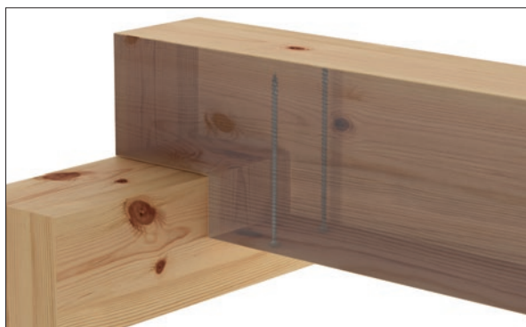
Zabezpieczenie przed pęknięciem belki z wcięciem
