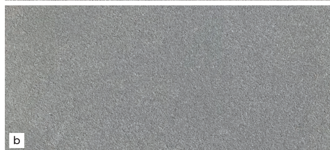
Fot. 5 a i b. Dzięki równomiernie rozłożonym w mieszance włóknom bazaltowym unikamy w efekcie końcowym plam, kłębków włókien na powierzchni posadzki. a – powierzchnia z włóknami polipropylenowymi, b – powierzchnia z włóknami bazaltowymi.
