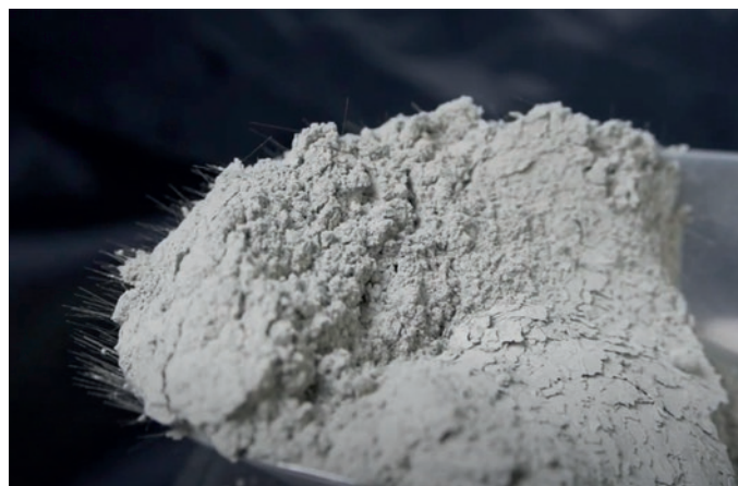
Fot. 4. Najprostszym testem sprawdzającym, czy włókna bazaltowe są obecne w mieszance, jest obejrzenie suchej mieszanki spoivo iX CPP20 Fibro w dobrym świetle.
