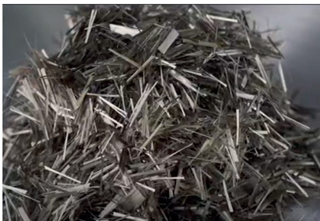
Fot.3. Włókna bazaltowe powstają z jednej z najtwardszych skał magmowych – bazaltu. Skała poddawana jest procesowi obróbki, który skutkuje powstaniem długich, cienkich wiązek bazaltu.
