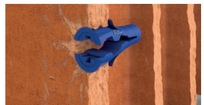
Rozpór od wejścia otworu uratuje pracę w razie montażu w zbyt dużym albo uszkodzonym lub wyrobionym otworze
