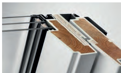
Elegancki i odporny na wilgoć profil okienny ThermoTechnology™ . Rdzeń drewniany, z drewna modyfikowanego termicznie, został pokryty ciśnieniowo wytrzymałym i w pełni odpornym na wodę poliuretanem pomalowanym na biało.
