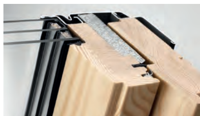
Wytrzymały i ciepły profil okienny ThermoTechnology™ , wykonany z klejonego impregnowanego i lakierowanego drewna sosnowego, łączonego z wysokoizolacyjnym tworzywem EPS.
