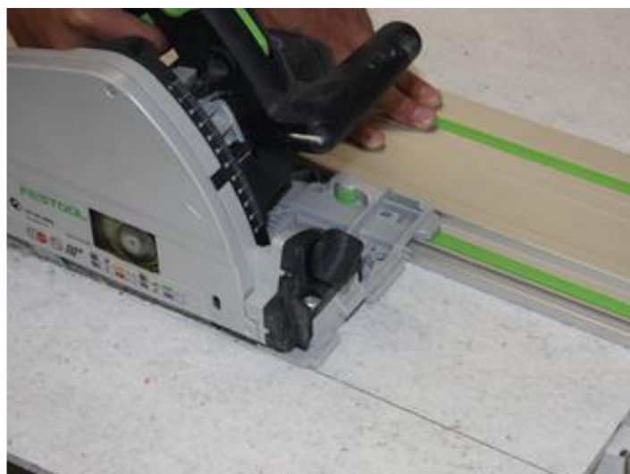
11 Obróbka i cięcie płyt izolacyjnych Sopro FDP 558 jest możliwe, np. przy użyciu wyrzynarki.
