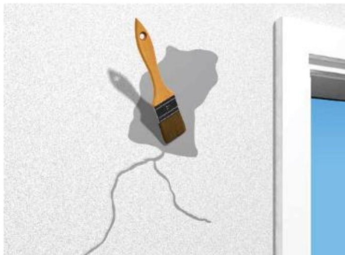
6 Uszczelnianie rys, pęknięć
