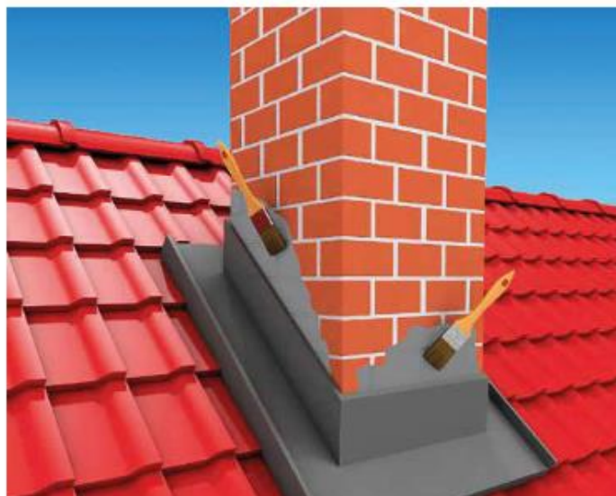
2 Niwelowanie nieszczelności przy obróbkach kominowych
