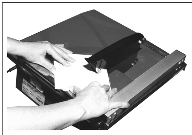
FOT. 5. Cięcie wzdłuż przekątnej
