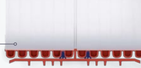
Połączenie rur strukturalnych Pragma+ID poprzez nasuwkę
