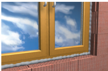
Uszczelnianie ościeżnic okiennych i futryn
